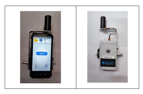
Pero igualmente podemos usar el equipo para cualquier otra actividad topográfica poniendo una antena GNSS convencional con su cable coaxial sobre un Jalón:
